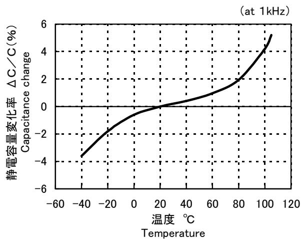
◇メタライズドポリプロピレンフィルムコンデンサ
