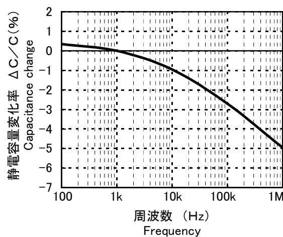
◇メタライズドポリプロピレンフィルムコンデンサ
